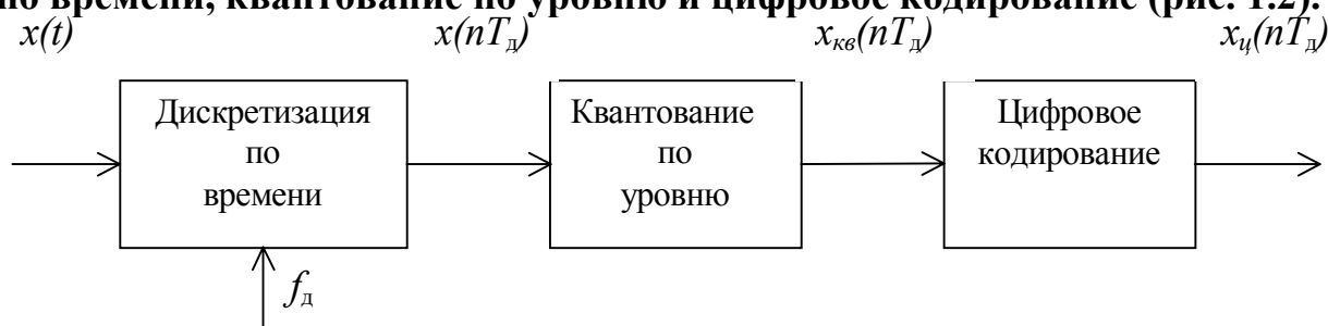
Рис. 1.2. Последовательность операций аналого-цифрового преобразования сигнала
